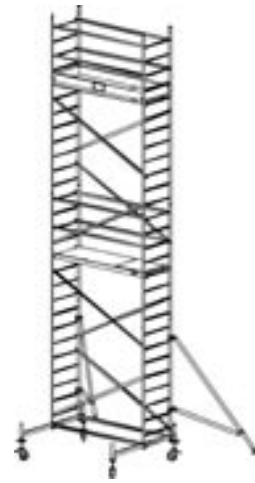
Art nr 910165P Wys.robocza: 8,3m Wys. ruszt.: 7,3m Wys. do pom.: 6,3m
